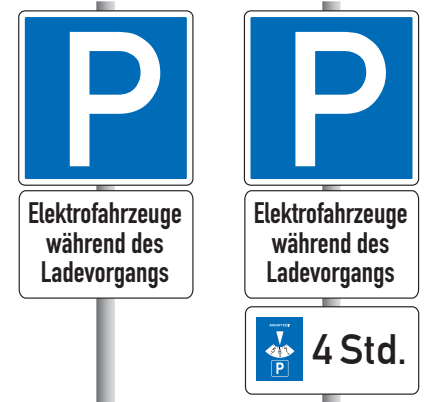
Links: Beschilderung zur Ausweisung von Stellplätzen für E-Autos während des Ladevorgangs Rechts: mit zeitlicher Eingrenzung mittels Parkscheibe innerhalb der Parkraumbewirtschaftungszone
